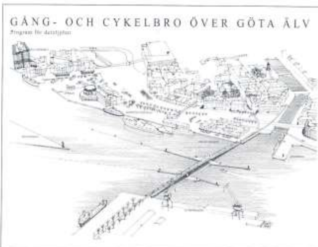
Den förslagna bron sedd från luften över Götawerken med Stenpiren till höger och Lilla Bommen till vänster. Förslaget har en öppning med ledverk åt båda hållen längs farleden. Teckning från Stadsbyggnadskontorets programhandling. Tecknare P G Hillinge, Sweco FFNS
